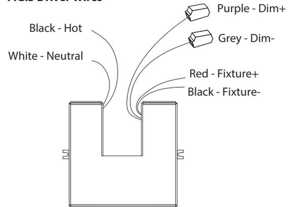
**FIG. 2 Wiring**
